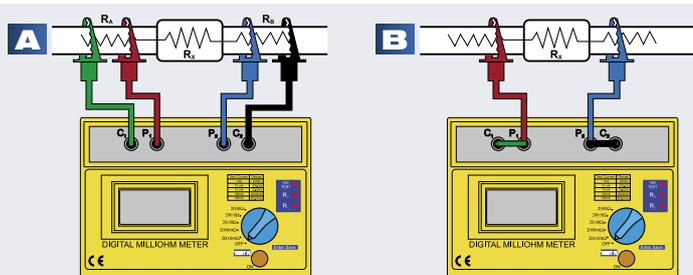
**A.** Четырёхпроводная схема измерения
